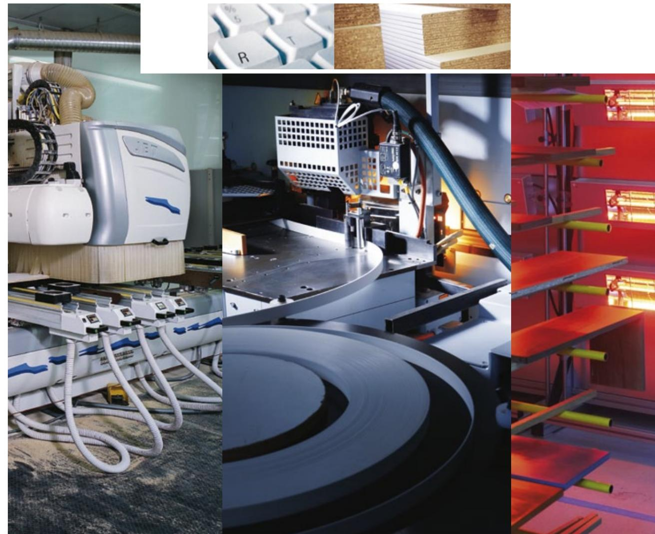
Aus unserer Produktion: CNC-Anlage BUSELLATO | Hochleistungs-Kantenleimer von HOMAG | Halogen-Oberflächentrocknung
